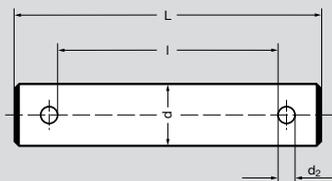
Каждый палец оснащен двумя шплинтами и, начиная с BL 1234 или F 38, дополнительно двумя шайбами.
