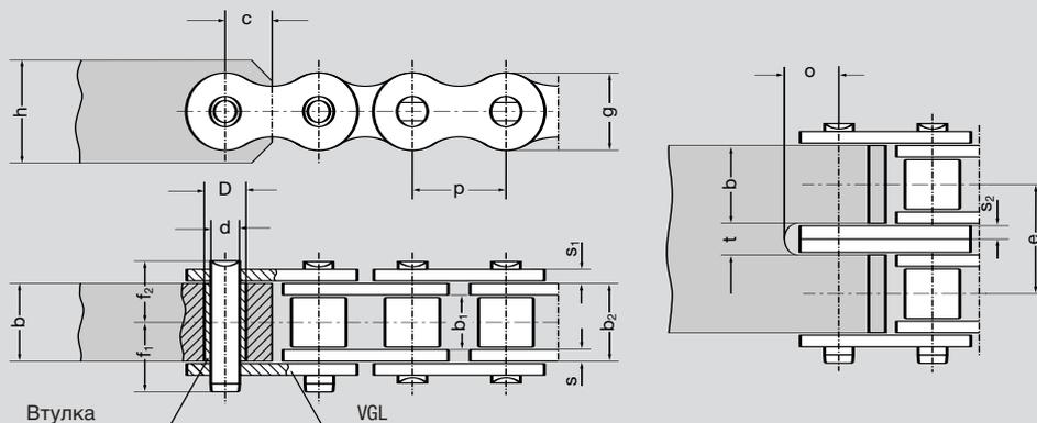
Прочность материала крепежных деталей должна составлять не менее 490 Н/мм<sup>2</sup>. При динамической нагрузке мы рекомендуем оснащать крепежный элемент втулкой. Твердость её поверхности достигает прибл. 60 HRC, что значительно повышает устойчивость к износу. Если нагрузка в основном будет статичная, то устанавливать закаленную втулку не требуется.
