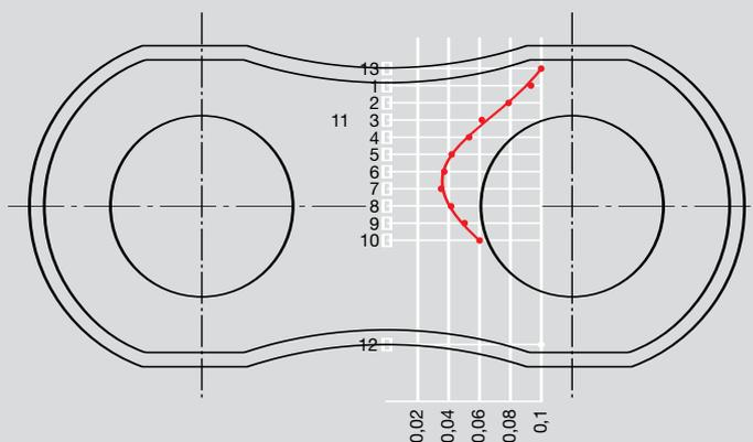
Измерение напряжения внутренней пластины при помощи измерительной полоски.
