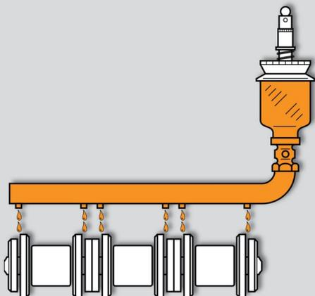
Рис. 6: Капельная смазка.
